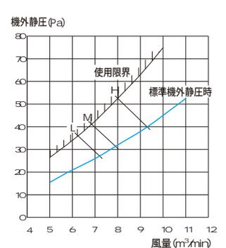
条件 (S50 40FLV) ダクト:φ150×5m 3本接続 曲がり3箇所 下吸込みパネル (BCL50)、天井吹出しチャンパ、グリル (KDTC939A13 KDTG939A13) 接続
