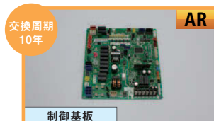
抵抗、コンデンサ、IC劣化による作動不良
