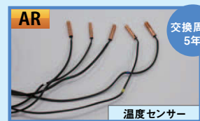
抵抗値の誤差、断線による温度検知不良
