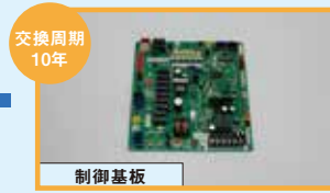
抵抗、コンデンサー、IC劣化による作動不良
