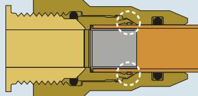
スリーブの爪部が配管に食い込むことで、抜けにくく、ガス漏れしにくい安心の構造。
