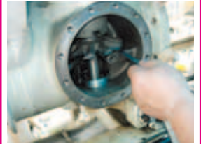
スリット隙間測定
